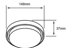
Vida útil: 15 000 h Tipo de lámpara: LED Integrado
