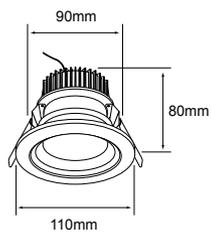
Vida útil: 40 000 h Tipo de lámpara: **LED Integrado**
