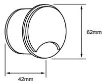
Vida útil: 30 000 h Tipo de lámpara: LED Integrado
