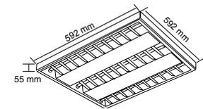
Vida útil: 15 000 h Tipo de lámpara: Tubular LED
