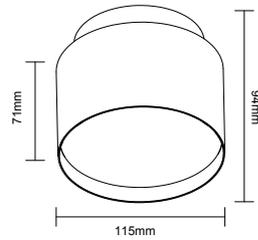
Vida útil: 50 000 h Tipo de lámpara: **LED Integrado**
