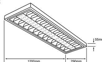
Vida útil: 15 000 h Tipo de lámpara: Tubular LED
