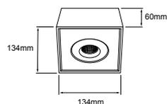
Vida útil: 50 000 h Tipo de lámpara: LED Integrado
