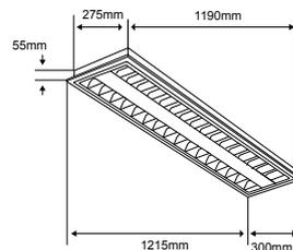
Vida útil: 15 000 h Tipo de lámpara: Tubular LED
