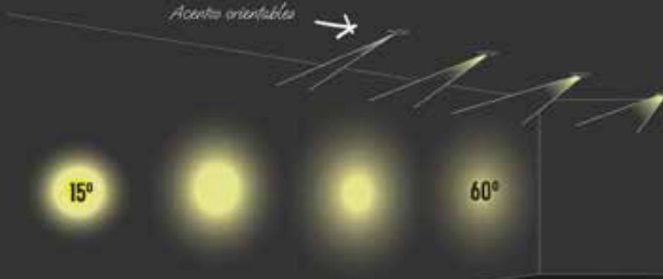
Para resaltar elementos en muro como un cuadro, es recomendable utilizar un **downlight dirigible** para orientar el haz de luz hacia la pintura.
