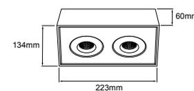
Vida útil: 50 000 h Tipo de lámpara: LED Integrado
